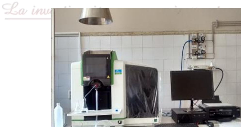
Figura 2.4. Equipo de absorción atómica del Laboratorio de Química Instrumental, de la Universidad Nacional de Trujillo.
