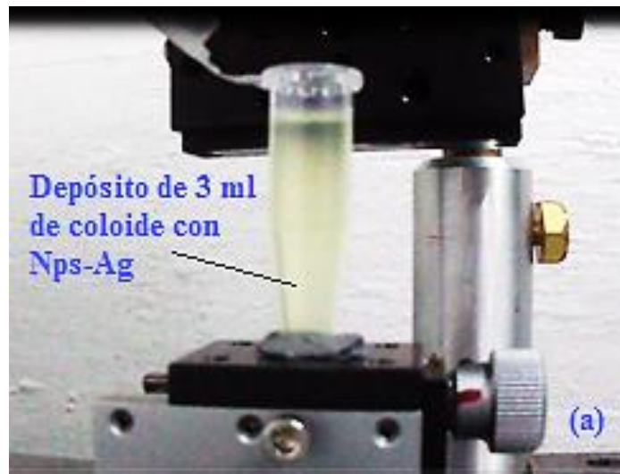
Figura 3.11. (a) Depósito de 3 ml de volumen, utilizado para irradiar (PLI).
