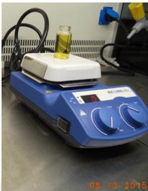
Figura A1.4 Formación de los coloides con AgNPs en agitación magnética.
