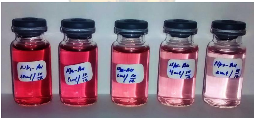
Figura 1.17. Nanopartículas de oro en estado coloidal, obtenidas por la técnica de Ablación Láser Pulsada en Agua. Laboratorio de Óptica y Láseres de la Universidad Nacional de Trujillo – Perú. CCADET-UNAM.
