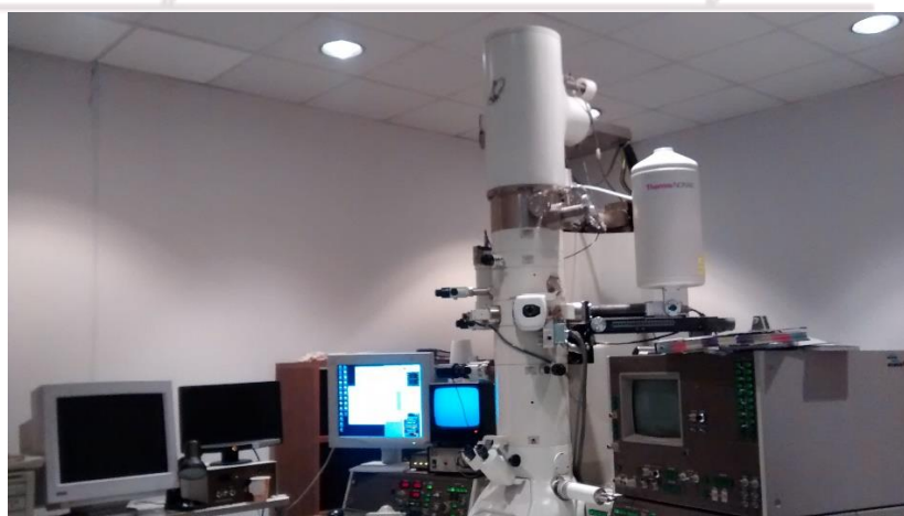
Figura 2.7. STEM ( Scanning Transmission Electron Microscopy ), marca JEOL modelo JEM 2010F, 200 KV de voltaje de aceleración.
