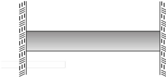
Figura 5.24: Vigas con sus dos extremos empotrados.
